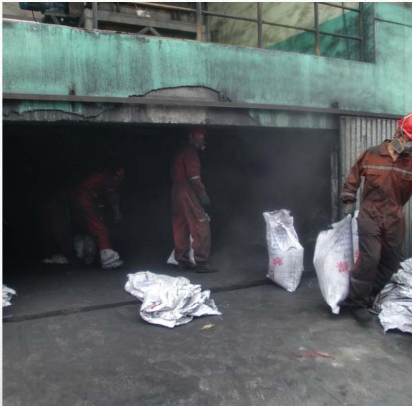
工人处理废汞触煤
